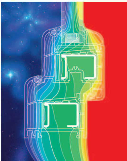
Termografía de una sección de EuroFutur Elegance
